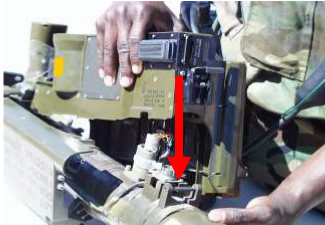
Надавити на передню частину ПМ в низ до фіксатора №2
