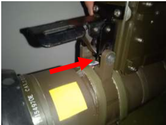
Зачепити фіксувальну скобу за фіксатор №2
