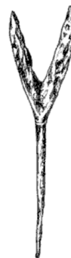
Рис. 6.9. Y-образный наконечник с наваренными рогами
