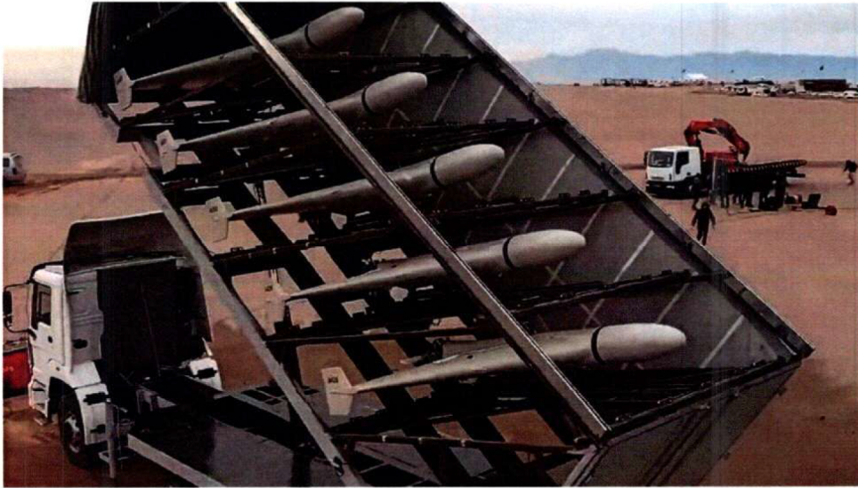
Рисунок 1.3. – Пускова установка БПЛА “Shahed 136” замаскована під самоскид.
