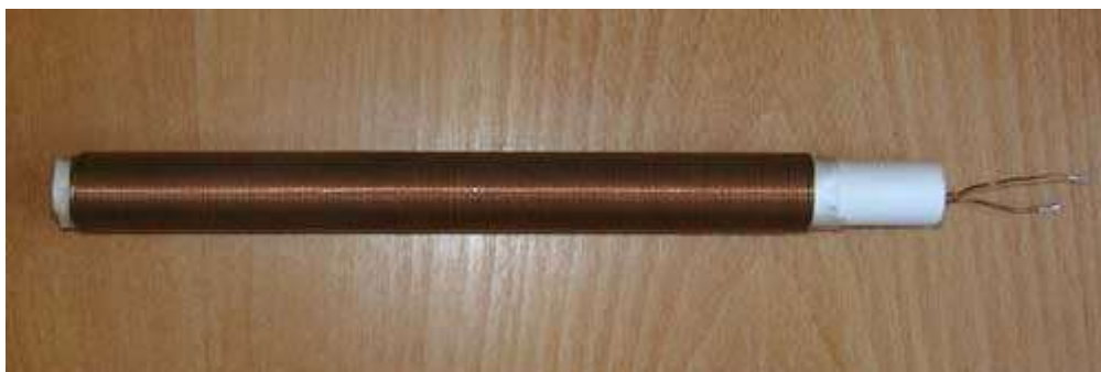
Рис. 14. Намотка экспериментального датчика
