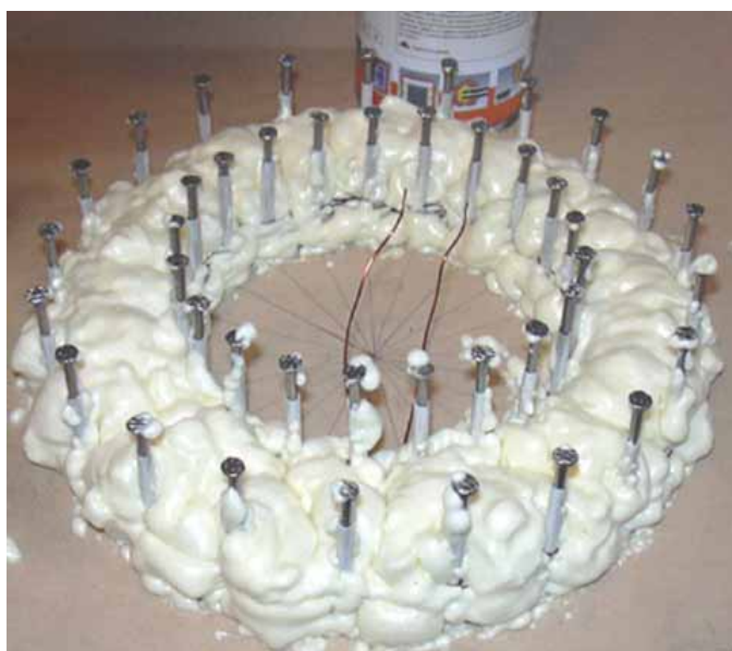
Рис.10. Корзиночный датчик после заливки пеной
