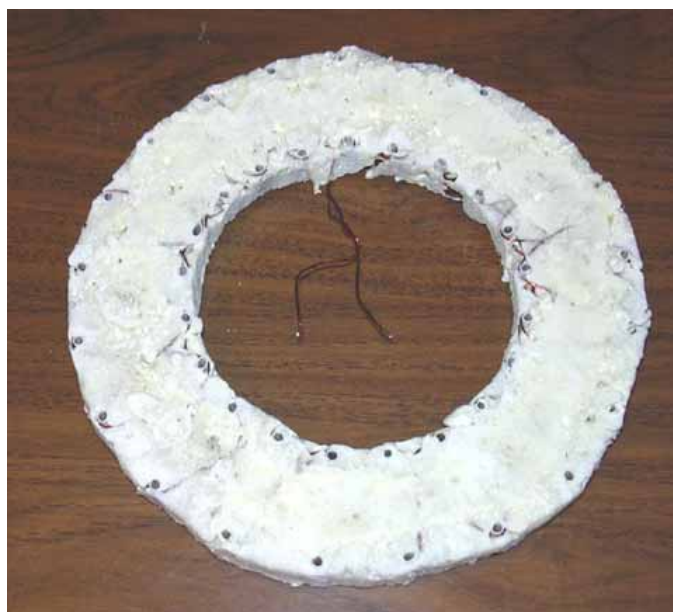
Рис.11. Корзиночный датчик после обрезки
