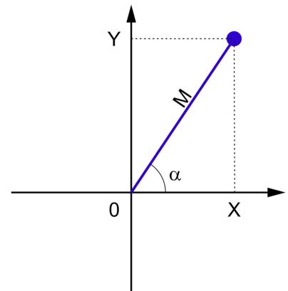
На экране в графическом виде отображаются проекции вектора разбаланса X (верхняя строка) и Y (нижняя строка), а так же в числовом виде размах разбаланса в милливольтах (верхняя строка) и угол вектора разбаланса в градусах (нижняя строка).
