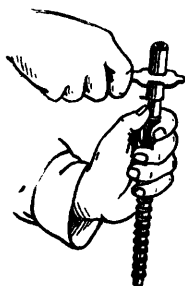
Рис. 36. Отделение газового поршня
