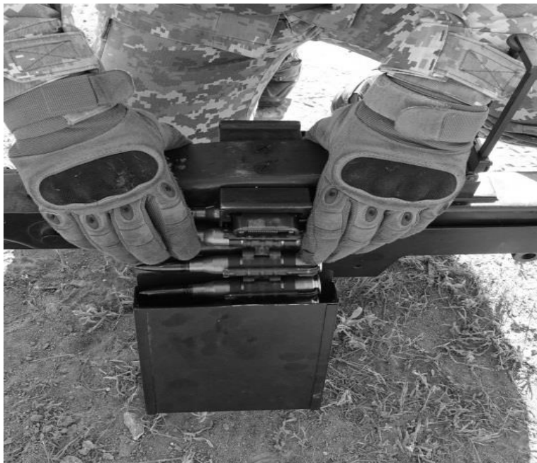
Рисунок 64 – влаштування стрічки в поперечне вікно стрікоприймача.
