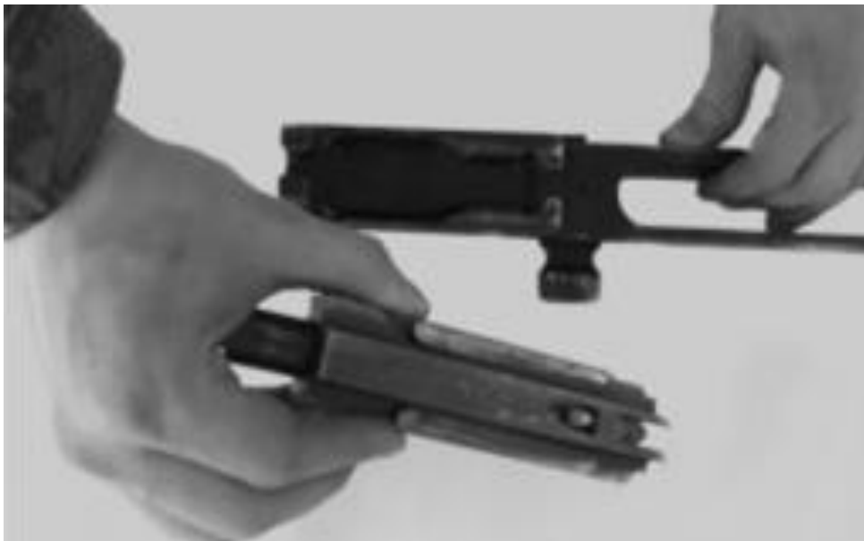
Рисунок 56 – порядок від'єднання затвора з рами.
