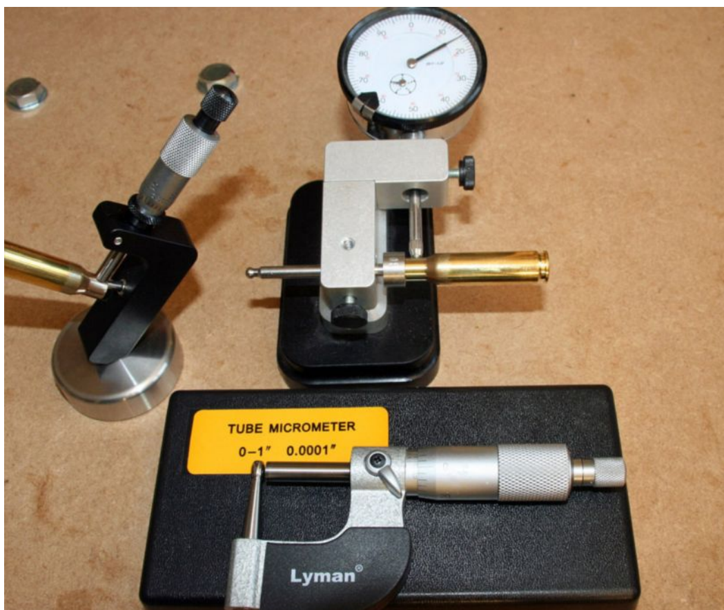
Набор инструментов для измерения шеек гильз: микрометр для шеек Lyman на переднем плане; сортировщик гильз Sinclair на заднем плане и дорогой трубчатый микрометр Starret для измерения шеек слева.
