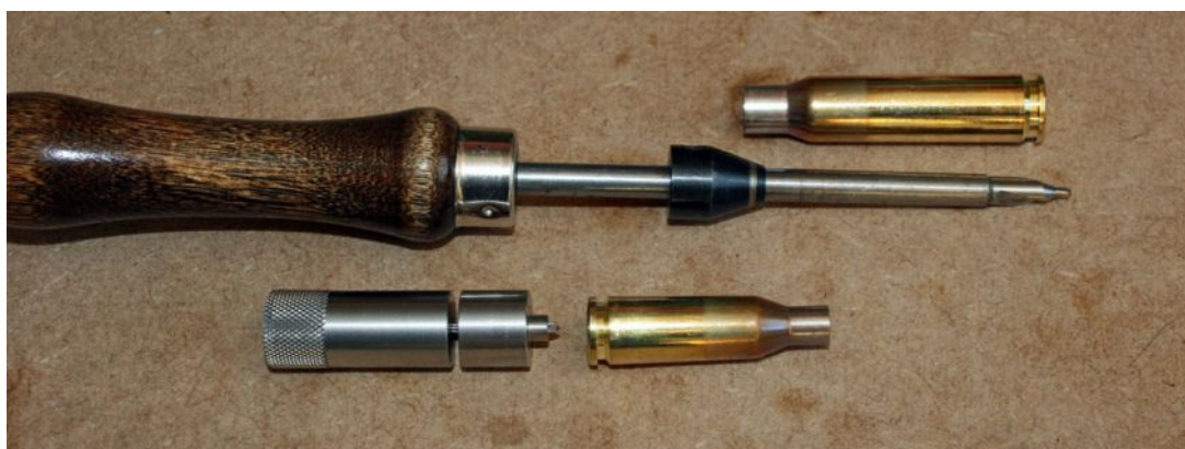
Инструмент Lyman для обработки запального отверстия гильз всех калибров (стержень .17/.20) (вверху), и развертка Sinclair (0.062") для запальных отверстий.
