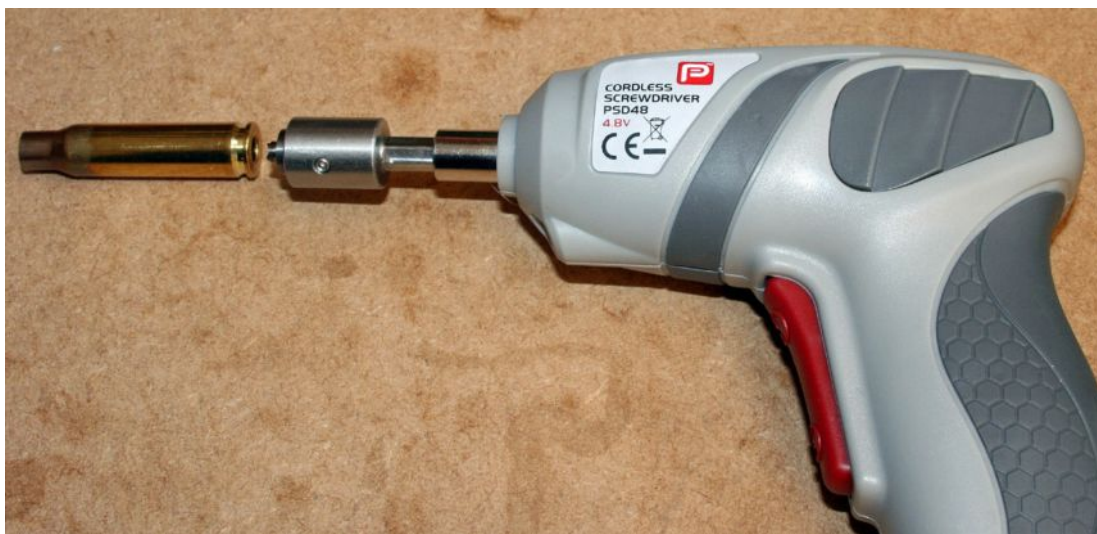
Инструмент для обработки запальных отверстий Sinclair на адаптере для ручного электроинструмента — беспроводные отвертки трансформировали эту и другие работы по подготовке гильз.
