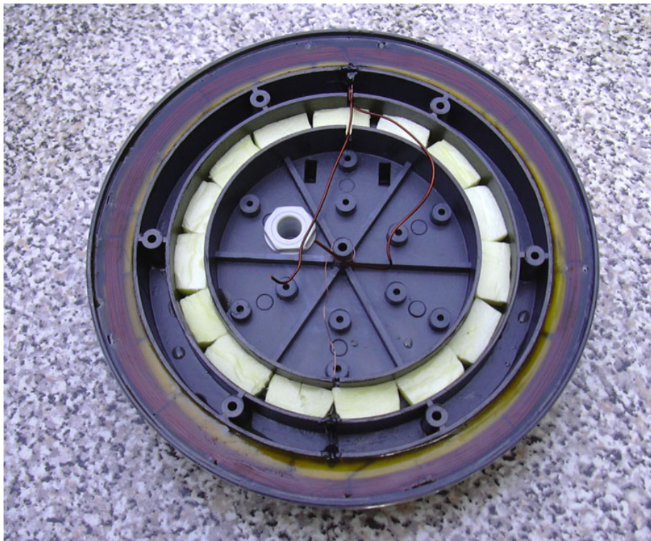
Рис. 13. Заливка передающей катушки.
