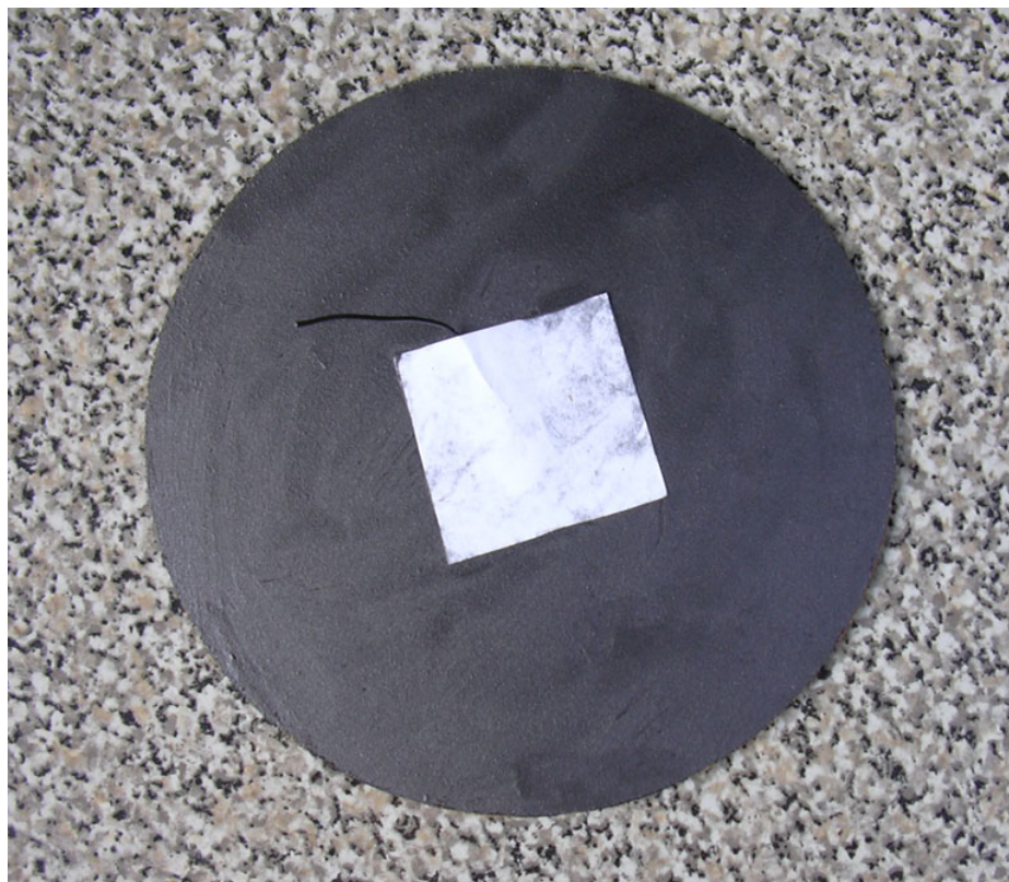
Рис.20. Крышка датчика с электрическим экраном
