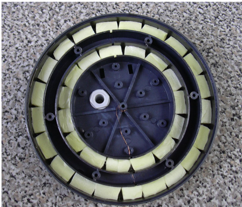
Рис. 12. Укладка пенопласта в пазы.
