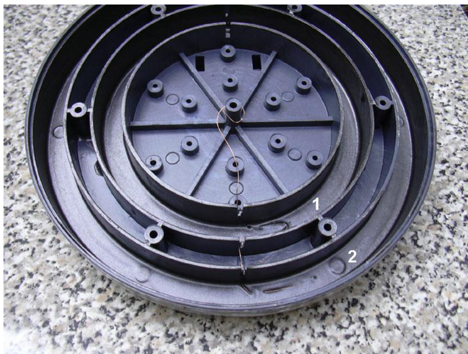
Рис. 11. Покрытие корпуса токопроводящим лаком.
