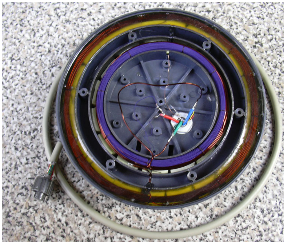
Рис. 15. Укладка и подпайка приемной и компенсирующей катушек.
