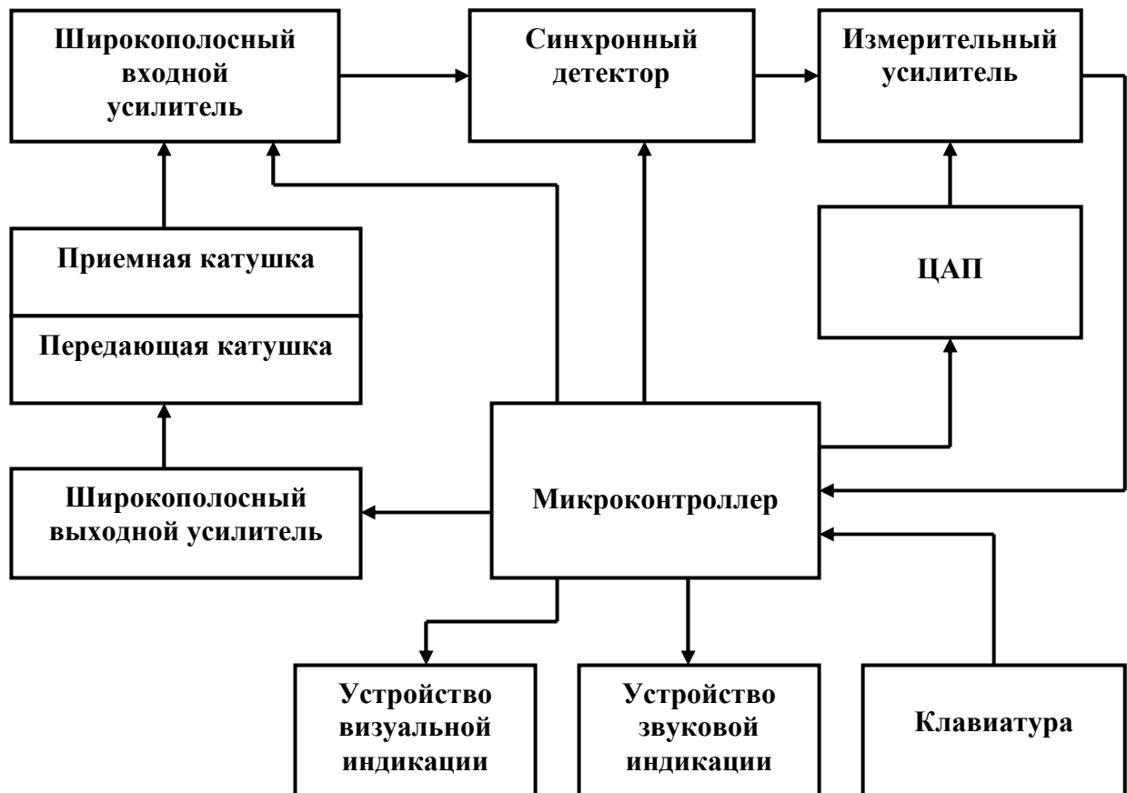
Рис.1. Структурная схема металлоискателя.
