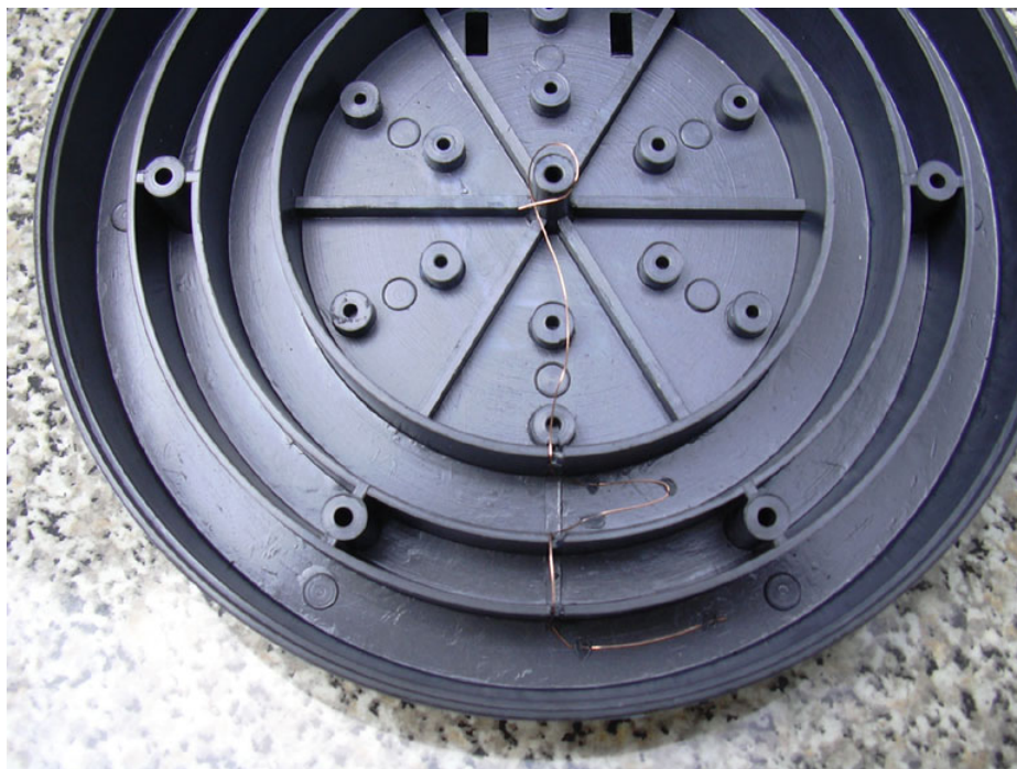
Рис. 10. Закрепление “заземляющего” вывода.
