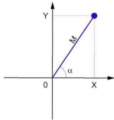
В каждом подпункте на экране в графическом виде отображаются проекции вектора разбалансировки X (верхняя строка) и Y (нижняя строка), а так же в числовом виде размах разбалансировки в милливольтах (верхняя строка) и угол вектора разбалансировки в градусах (нижняя строка).
