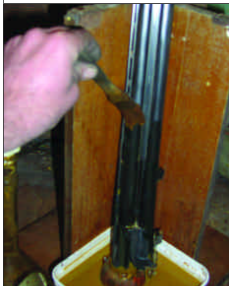
второе нанесение ржавого лака
